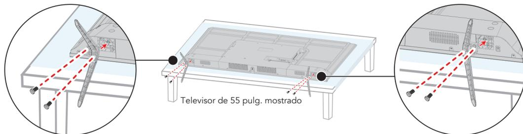
43 pulg. Tornillos ST4 (18 mm de longitud) (4)
